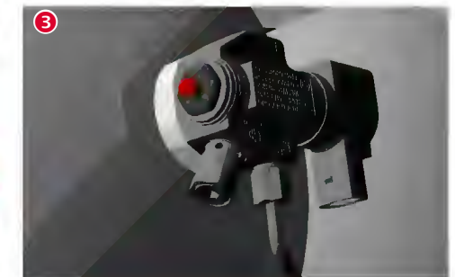
3 Absperrventil mit 5-er Maulschlüssel bzw. Zange oder Spezialwerkzeug im Uhrzeigersinn bis zum Anschlag drehen.
