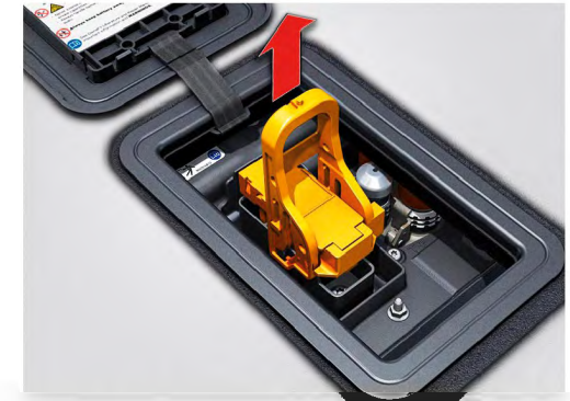
Hebel nach oben klappen und Stecker nach oben herausziehen.
