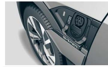
Ladeanschluss „e-tron“ am Kotflügel (beidseitig möglich)
