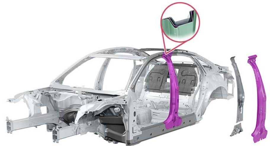
B-Säule mit mehrschaligem Aufbau
