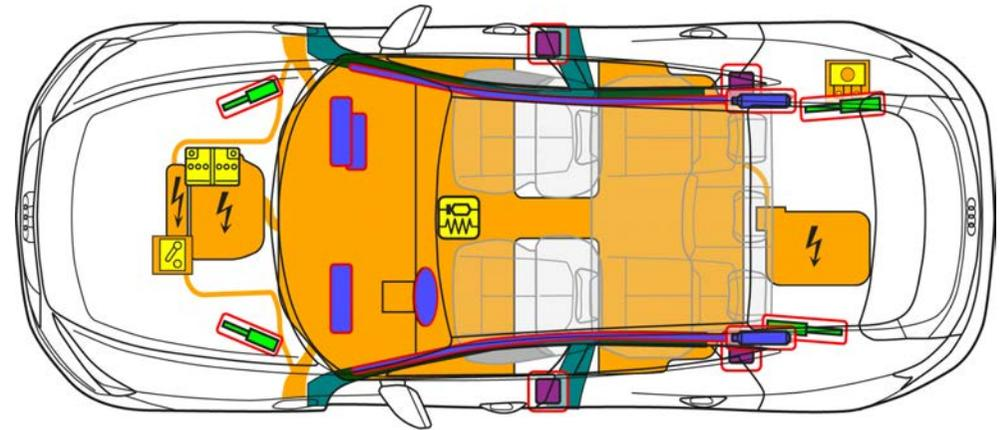
Hochvolt-Batterie im Fahrzeugboden (Audi Q4 e-tron)
