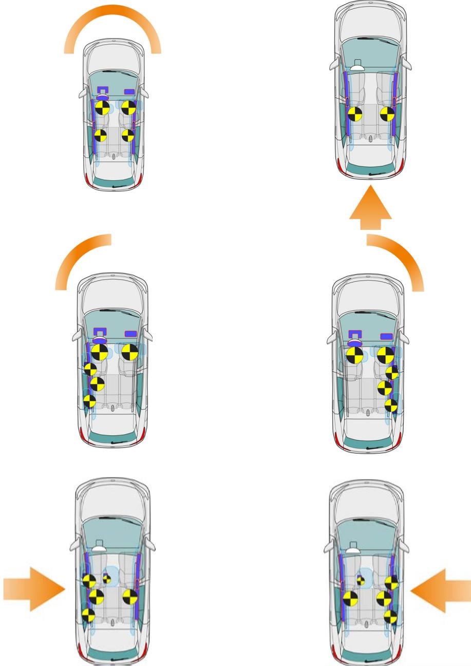
Die Auslösung der Sicherheitssysteme erfolgt in Abhängigkeit von der Unfallart bzw. der Anstoßrichtung (ms = Millisekunden).
