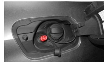
Erdgas-Anschluss am Tankeinfüllstutzen
