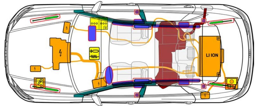
Hochvolt-Batterie vor der Hinterachse (Audi A3 TFSI e)
