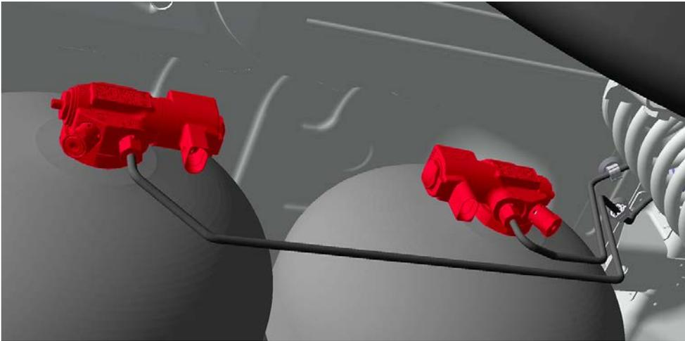
Absperrventil mit 5-er Maulschlüssel bzw. Zange oder Spezialwerkzeug im Uhrzeigersinn bis zum Anschlag drehen.
