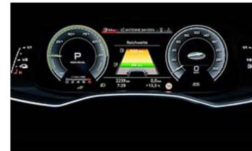
Digitales frei programmierbares Kombi-Instrument mit Powermeter und Ladestandsanzeige
