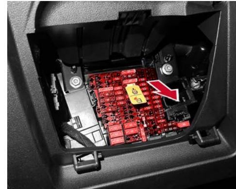
Trennstelle im Fahrgastraum, Armaturentafel am Sicherungsträger
