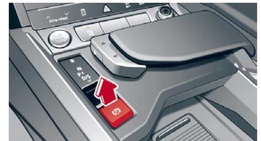
Schalter der elektrischen Feststellbremse
