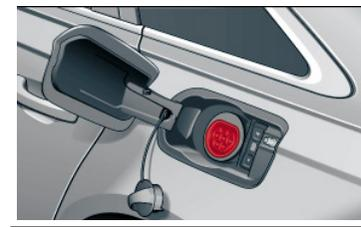
Ladeanschluss A6 „TFSI e“ am Seitenteil hinten
